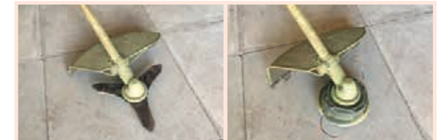
Met een bosmaaier met slagmes (links) worden de planten meer afgesneden en zijn daardoor beter af te harken. Dit is lastiger als er met een bosmaaier met draadkop (rechts) gewerkt wordt, want die versnipperd het maaisel te veel.
