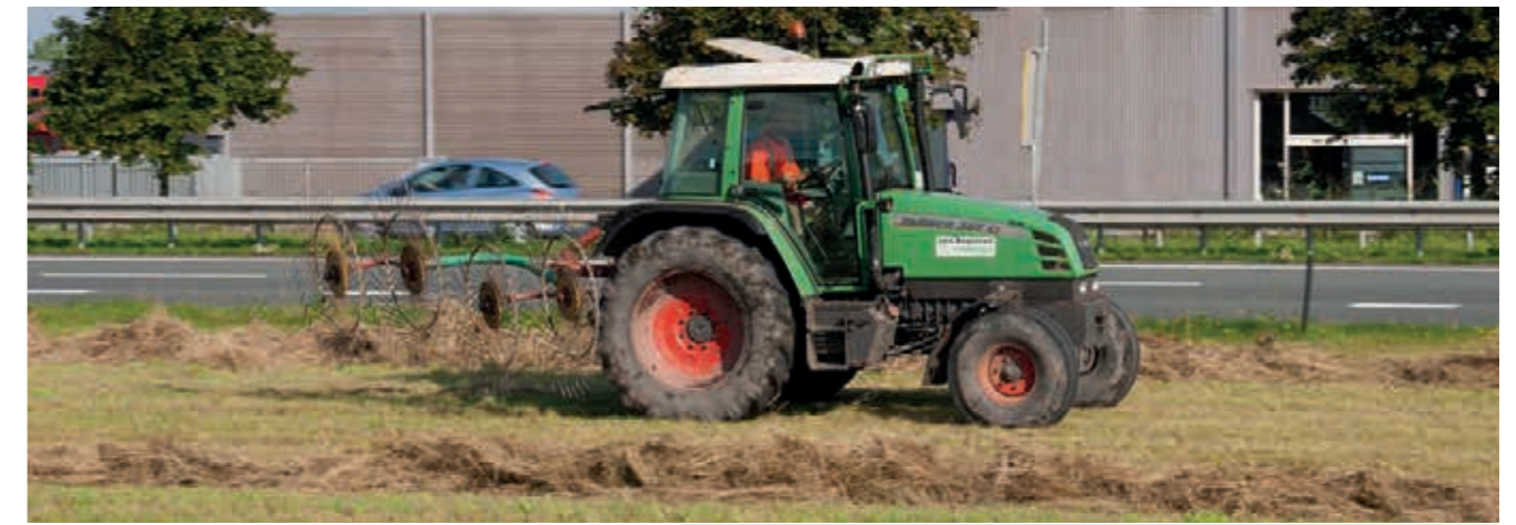
Met de hooihark achter de trekker kun je het maaisel mooi bijeen harken.
