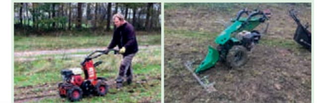
De zode afplaggen met een zodensnijder (links). Messenbalk (rechts).
